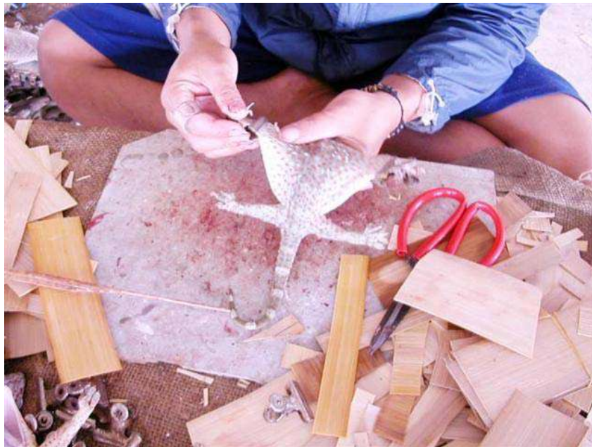
ภาพที่ 24 ยึดขอบหนังกับไม้แปด้วยตัวหนีบโลหะป้องกันการหลุดตัว
